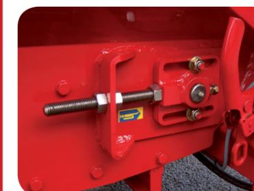
2 tendeurs de tapis de gros Ø équipent les caisses en extérieur, ce qui évite les encrassements et permet une tension rapide
