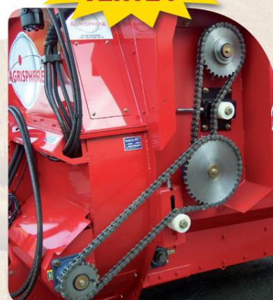
L'entraînement des démêleurs est assuré par des chaînes et pignons surdimensionnés, montés sur des **arbres de Ø50 traversant**. Une sécurité boulon est montée sur le pignon de sortie boîtier en complément de la **sécurité** qui équipe le **cardan** livré avec la machine.
