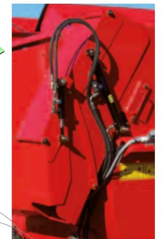
Les casquettes peuvent être commandées hydrauliquement (option) et permettre du tracteur d'orienter le jet sortant au pied de la machine. Cette fonction est idéale pour pailler derrière les cornadis.
