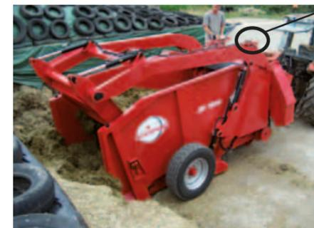
Le chargement au silo est rapide et propre grâce à une griffe droite équipée d'un racleur automatique.
