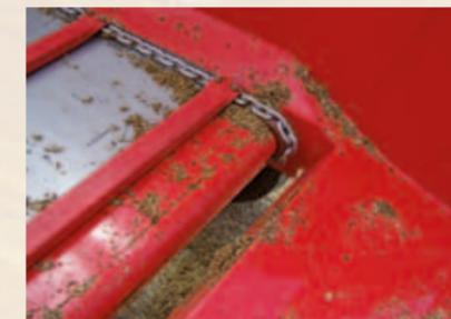
**2 tendeurs** de tapis de gros Ø équipent les caisses en extérieur, ce qui évite les encrassements et permet une tension rapide
