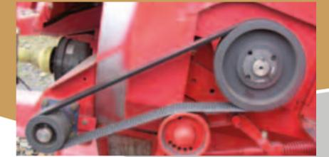
Un entraînement du démêleur bas par courroie est disponible (en option) sur les modèles entraînement mécanique.
