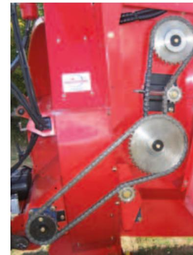
Dans la version mécanique l'entraînement des démêleurs est assuré par des chaînes et pignons surdimensionnés, montés sur des arbres de Ø50 traversant. Une sécurité boulon est montée sur le pignon de sortie boîtier en complément de la sécurité qui équipe le cardan livré avec la machine.
