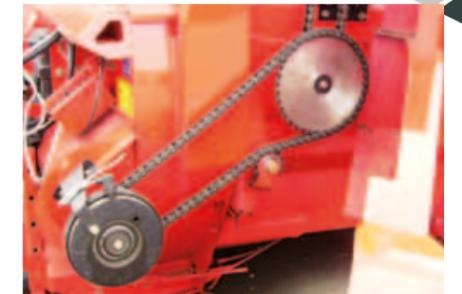
Une version avec embrayage électromagnétique permettant de bloquer l'entraînement des démêleurs le temps que la turbine se lance est disponible en option.
